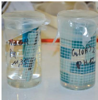
Figure 2 : Essai de durabilité du collage des mosaïques sur treillis.
