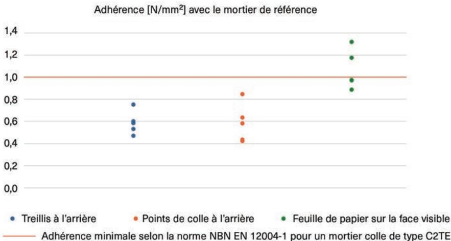
**Figure 3 :** Résultats des tests d'adhérence sur des éléments de mosaïque avec trois méthodes d'assemblage différentes..
