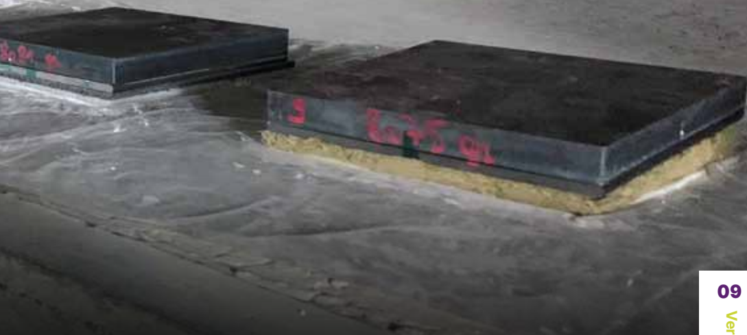
Afbeelding 1: Belasting van de proefstalen (200 × 200 mm) met een stalen plaat van 8 kg over een periode van iets meer dan een jaar.
