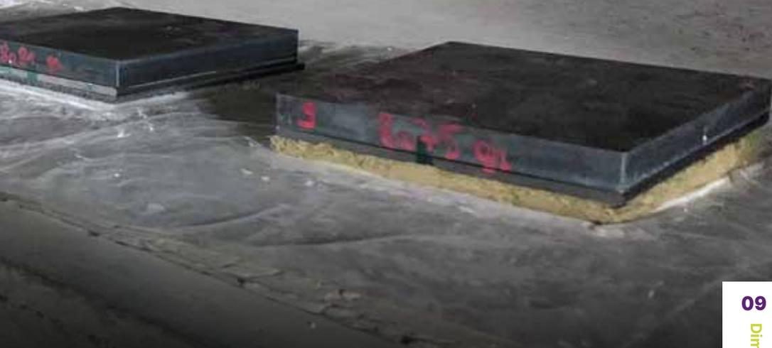
**Figure 1:** Mise en charge des échantillons (200 × 200 mm) à l'aide d'une plaque d'acier de 8 kg sur une période d'un peu plus d'un an.
